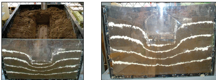
Rys. 4. Zagęszczenie gleby po nacisku stemplem z protektorem opony kierowanej siłą 9 kN – widok z góry i z przodu
