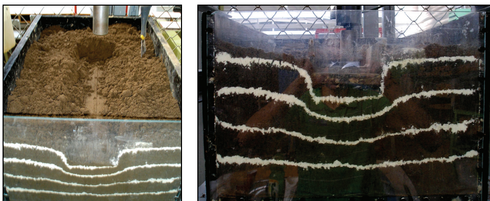
Rys. 3. Zagęszczenie gleby po nacisku stemplem z protektorem opony kierowanej siłą 3 kN – widok z góry i z przodu
