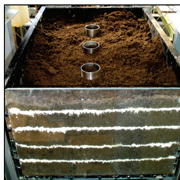
Rys. 1. Gleba przygotowana do zagęszczenia oraz pobór próbek do ustalenia gęstości początkowej i wilgotności
