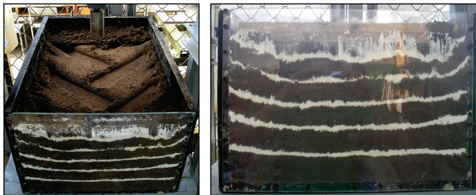
Rys. 5. Zagęszczenie gleby po nacisku stemplem z protektorem opony napędowej nowej siłą 3 kN – widok z góry i z przodu
