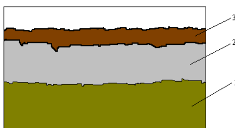
Рисунок 1 - Расслоение жидкого навоза на фракции: 1-нижний слой; 2-средний слой (жидкая фракция); 3-верхний слой (поверхностная корка)
