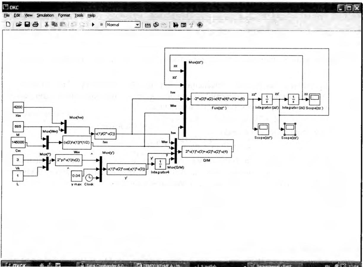
Рисунок 3. Блок-схема для одномассовой эквивалентной колебательной системы
