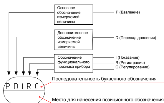
Рисунок 17 – Принцип построения условного обозначения прибора
