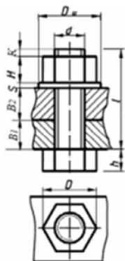
Рисунок 1 – Упрощенное изображение соединения болтом
