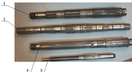
Рисунок 4 – Фотография валов коробки перемены передач трактора К-701: 1 – ведущего, 2 – грузового, 3 – привода насоса, 4 – промежуточного
