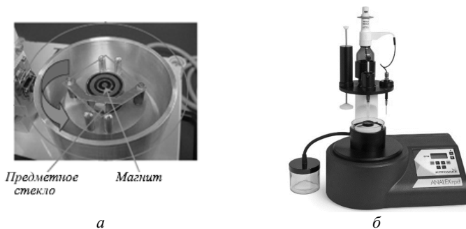
Рисунок 3 – Феррограф вращающегося типа: а – схема; б – внешний вид
