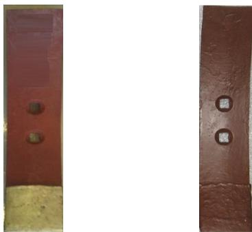
Рисунок 3 – Рыхлительные обратные лапы культиваторов упрочненные диффузионным намораживанием с последующей импульсной закалкой
