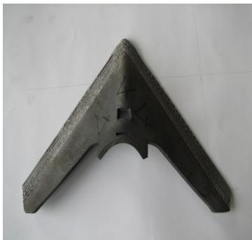
Рисунок 4 – Стрелчатая лапа культиватора упрочненная плазменной наплавкой с последующей импульсной закалкой
