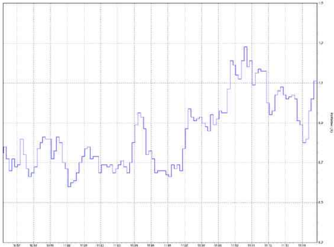
Рис. 5. График изменения уровня коэффициента несимметрии напряжения по обратной последовательности на ТП 648 «н.п. Дещенка ВРУ молочно-товарного комплекса (ввод 2)»
