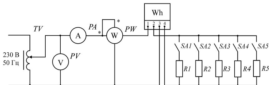
Рис. 2.3. Схема проверки однофазного индукционного счетчика:
