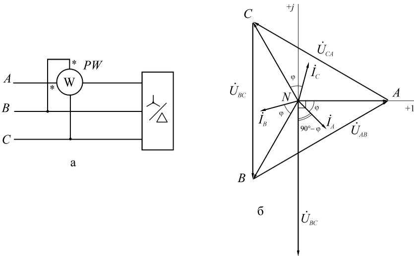
*Рис. 7.1.* Измерение реактивной мощности в трехфазных симметричных системах:
