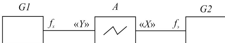
Рис. 9.6. Схема установки для измерения частоты методом фигур Лиссажу:
