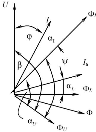
Рис. 2.2. Векторная диаграмма одноэлементного индукционного счетчика
