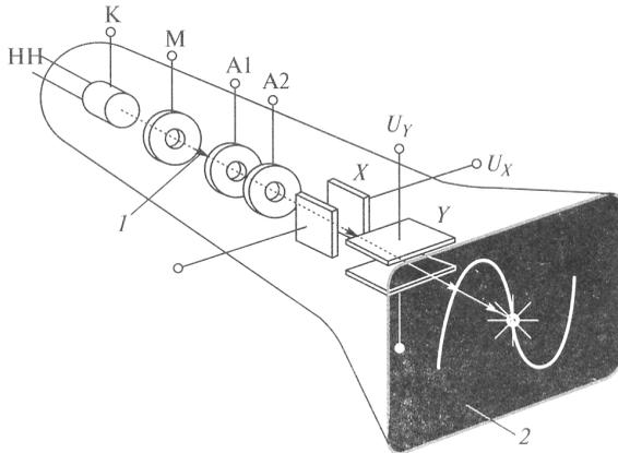
Рис. 9.1. Устройство ЭЛТ:
