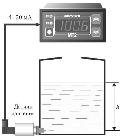
Рис. 14.7. Гидростатический уровнемер
