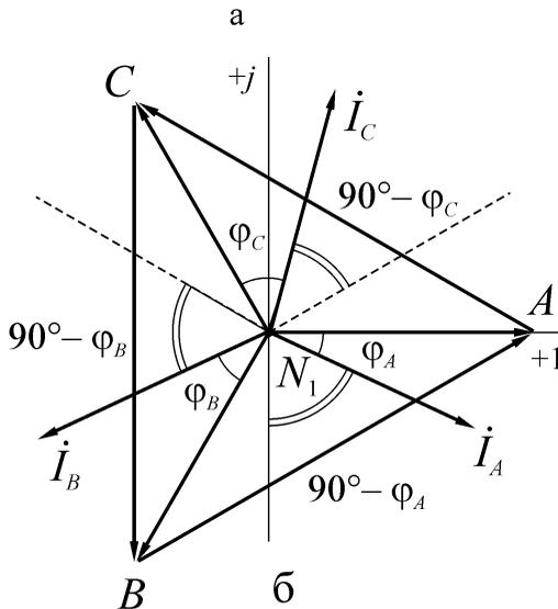
Рис. 7.3. Измерение реактивной мощности в трехфазных четырехпроводных цепях (соединение звездой с нулевым проводом) с простой асимметрией:
