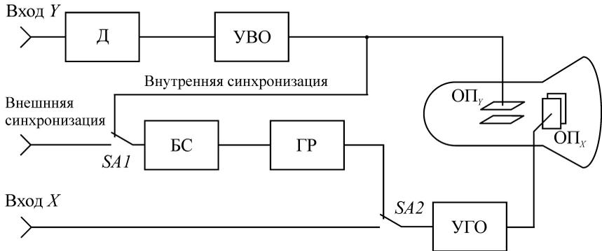
Рис. 9.3. Структурная схема электронно-лучевого осциллографа:
