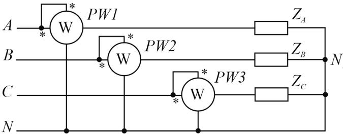
Рис. 6.4. Схема включения ваттметров по методу трех приборов
