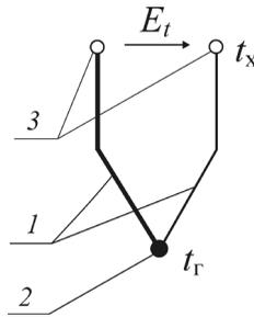
Рис. 13.2. Термоэлектрический преобразователь (термопара):
