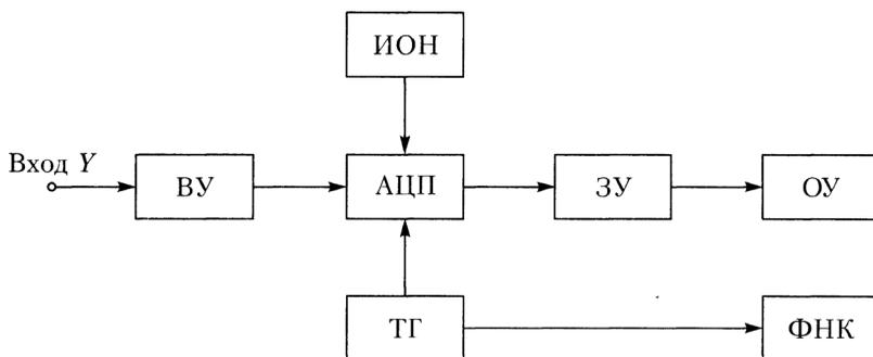
Рис. 9.4. Структурная схема цифрового запоминающего осциллографа
