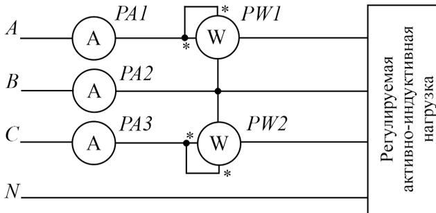
Рис. 6.5. Схема лабораторной установки
