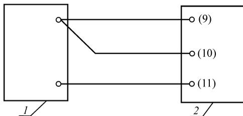
Рис. 13.4. Схема подключения магазина сопротивлений к измерителю-регулятору МТ2:
