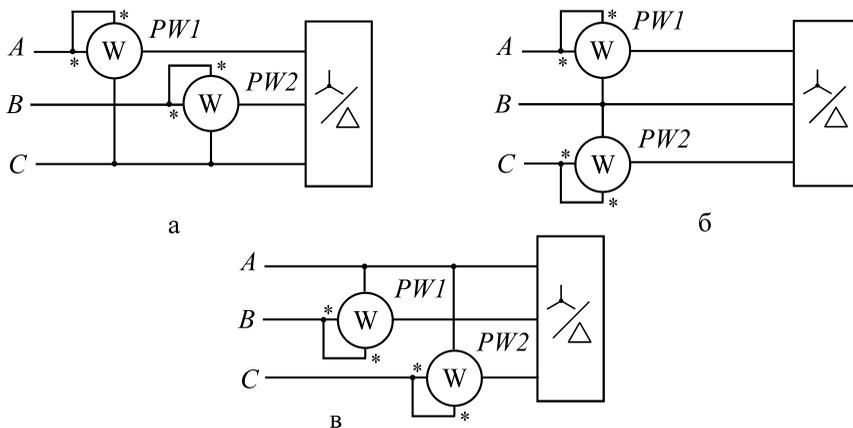
Рис. 6.2. Схема включения ваттметров по методу двух приборов в соответствии с формулой:
