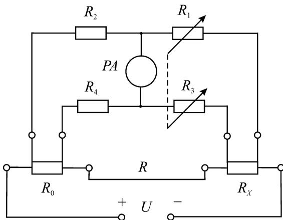
Рис. 5.2. Схема двойного моста постоянного тока
