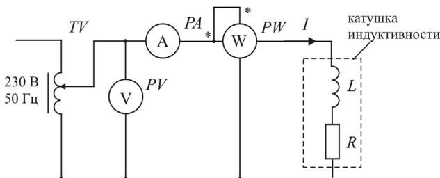
Рис. 17.1. Схема косвенного измерения сопротивления
