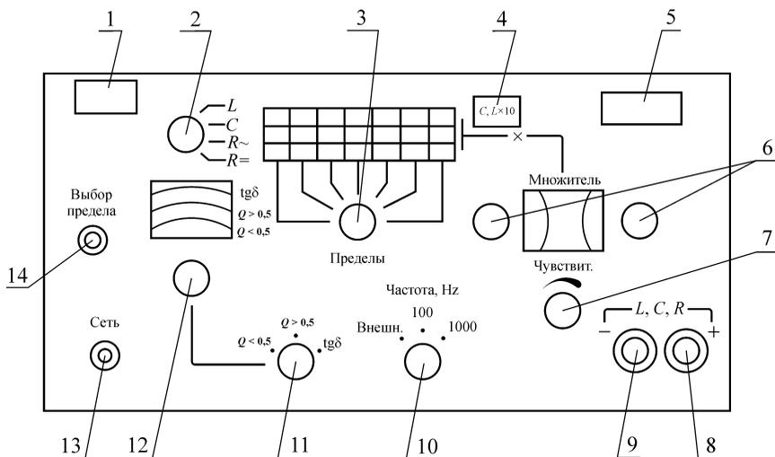
Рис. 8.3. Передняя панель измерителя  $L, C, R$  универсального E7-11
