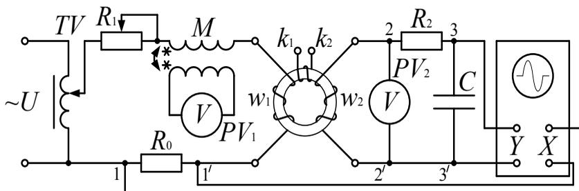
Рис. 11.2. Схема для получения динамических характеристик ферромагнитных материалов осциллографическим методом
