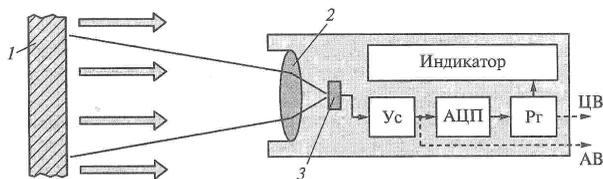
Рис. 15.1. Упрощенная структура пирометра полного излучения:
