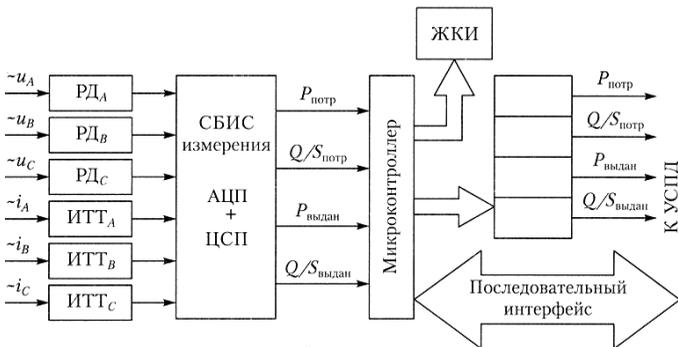
Рис. 18.1. Блок-схема многофункционального микропроцессорного счетчика электроэнергии
