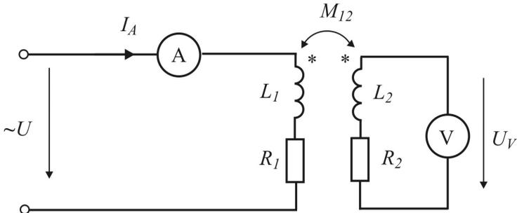
Рис. 10.3. Косвенное измерение взаимной индуктивности с использованием амперметра и вольтметра с большим входным сопротивлением
