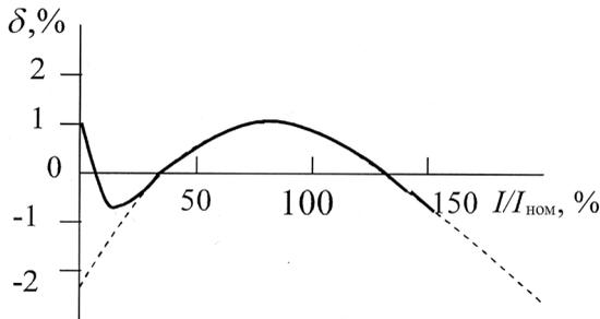
Рис. 2.4. Примерный вид нагрузочной характеристики счетчика
