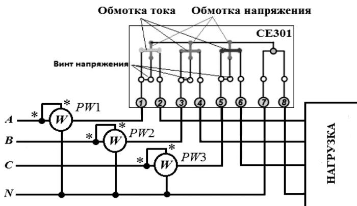
Рис. 18.3. Схема подключения трехфазного счетчика
