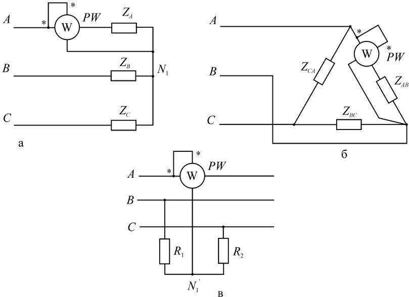
Рис. 6.1. Схемы включения ваттметра при измерении мощности в симметричных цепях методом одного прибора:
