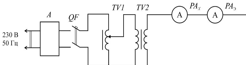
*Рис. 1.1.* Схема лабораторной установки для проверки амперметра:
