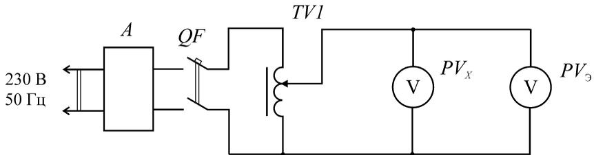
Рис. 1.2. Схема лабораторной установки для поверки вольтметра:
