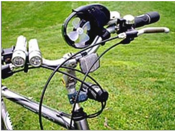
Рис. 4.19. Миниатюрный ветрогенератор для велосипеда
