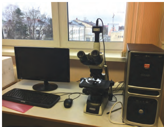
Рисунок 1 – Микроскоп ЛОМО с камерой digital Camera for Microscope DCM310 (USB2/0) 3M pixels, CMOS для оценки размеров пор пивоваренного ячменя
