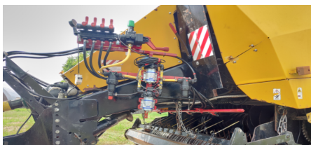
Рисунок 1. Общий вид макетного образца для ввода консервантов на тюковом пресс-подборщике ПТ-800
