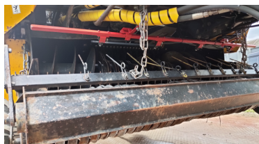
Рисунок 1. Общий вид макетного образца для ввода консервантов на тюковом пресс-подборщике ПТ-800
