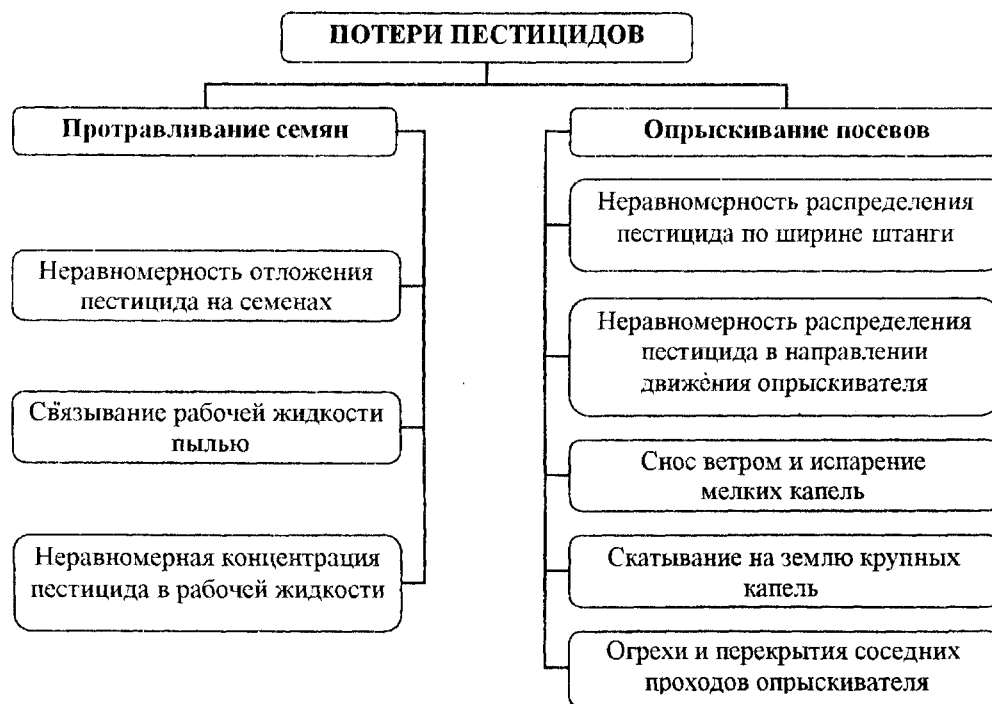
Рис.1. Потери пестицидов при использовании протравливателей и штанговых опрыскивателей
