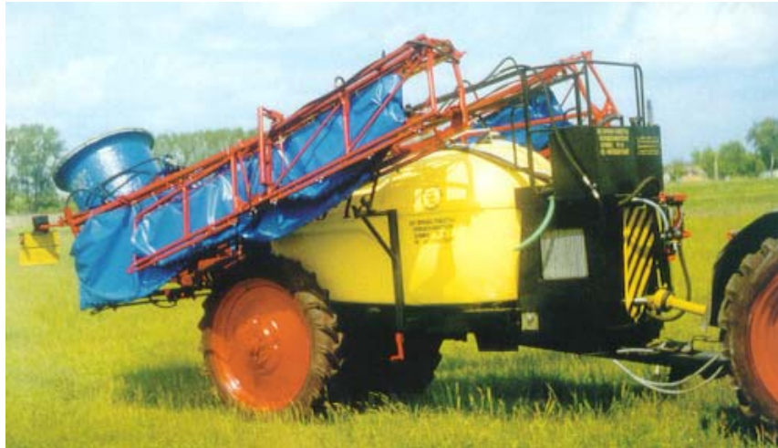
Рис. 3. Опрыскиватель с системой воздушного сопровождения капель рабочего раствора (ветрозащитное устройство активного действия)
