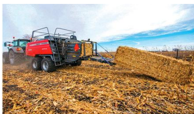
Рисунок 3. Уборка кукурузной соломы тюковым пресс-подборщиком
