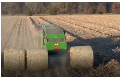
Рисунок 2. Уборка кукурузной соломы рулонным пресс-подборщиком
