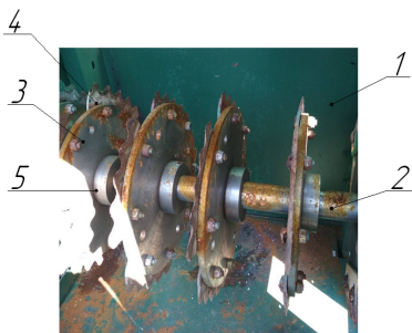
1 – корпус, 2 – вал, 3 – диски, 4 – ножи, 5 – подшипники
