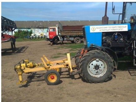
Рисунок 1. Комбинированный агрегат для измельчения растений и заделки их в почву
