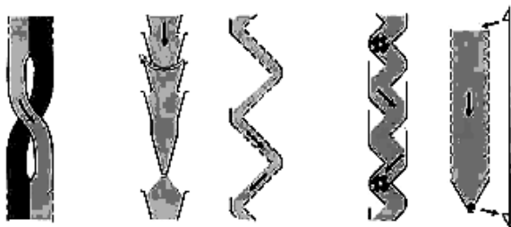
Рис. 1.3. Устройства ворошения и перемешивания слоя зерна в колонковых зерносушилках
