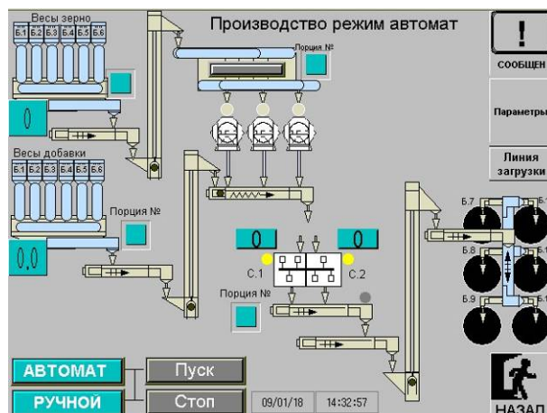
Рисунок 2 - Общий вид панели управления АСУ ТП комплекта комбикормового оборудования КОКК-10
