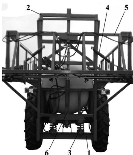
Rys. 8. System stabilizacji belki polowej opryskiwacza zawieszanej bezpośrednio na cylindrze hydraulicznym: 1 – rama opryskiwacza, 2 – ruchome zawieszenie belki, 3 – sprężyny podporowe ramy, 4 – amortyzatory, 5 – belka opryskowa, 6 – rama podwozia maszyny
