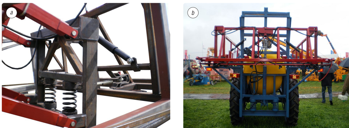
Рис. 3. Разработанные системы стабилизации штанги опрыскивателей «Мекосан-2500-18» (а) и ОШ-2300-18 (b) Fig. 3. Designed rod stabilization systems for sprayers Mekosan-2500-18 (a) and OS-2300-18 (b)
