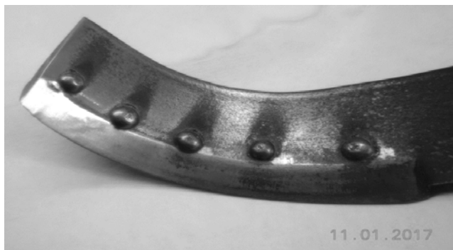
Рисунок 3 – Упрочнение почворезущей поверхности деталей точечной наплавкой износостойкого покрытия дугой плавящегося электрода
