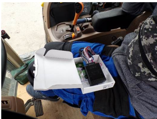
Рисунок 2 - Установка универсального программируемого бортового контроллера CAN-WAY к средствам подключения к шине CAN (CAN-L, CAN-H) трактора John Deere 7830
