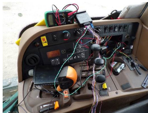
Рисунок 2 - Установка универсального программируемого бортового контроллера CAN-WAY к средствам подключения к шине CAN (CAN-L, CAN-H) трактора John Deere 7830
