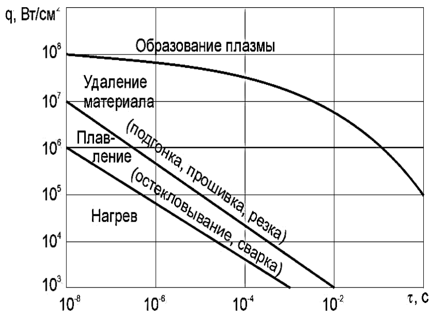
Рис. 5.5. Диаграмма процессов, происходящих при лазерной резке
