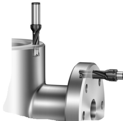
Рис. 2.11. Примеры использования сверл со сменными твердосплавными пластинами при обработке заготовок деталей на многооперационных станках с ЧПУ
