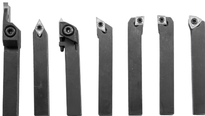
Рис. 2.4. Фотографии универсальных токарных резцов с быстросменными многогранными твердосплавными пластинами
