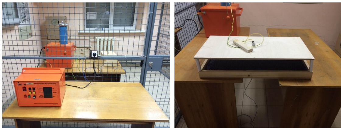
а) б) Рисунок 1-Высоковольтный аппарат СКАТ 70 для создания переменного электрического поля (а) и экспериментальная ячейка (б)
