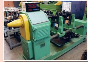
Справочно: Балансировке на станке могут подвергаться только межопорные роторы. Балансировка роторов, создающих при вращении большие вентиляционные потоки, должна проводиться в кожухах. Плоскости коррекции в пределах длины балансируемого ротора могут быть выбраны в наиболее удобной его части, причем взаимное влияние плоскостей коррекции отсутствует. Количество корректирующей массы определяется по показанию стрелочного индикатора значения дисбаланса.
