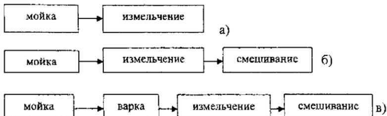
Рис. 4.30 Технологическая схема обработки корнеклубнеплодов: а – при выгрузке в кормораздатчик; б, в – в кормощах
