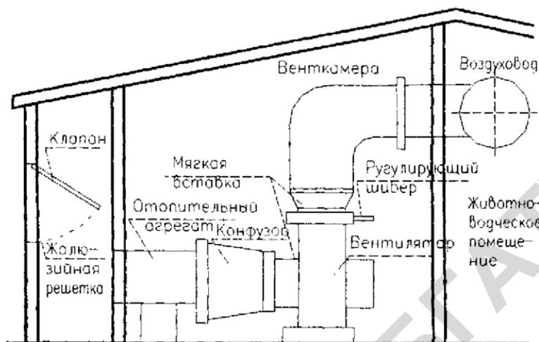
Рис. 4.64 Размещение оборудования в вентиляционной камере
