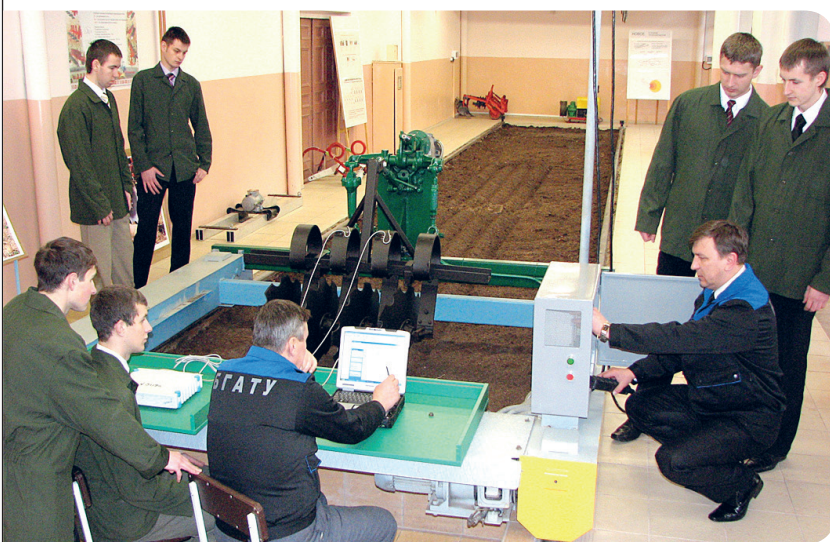
Снятие силовых характеристик с рабочих органов почвообрабатывающих машин методом тензометрирования
