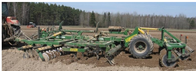
Рисунок 2. – Модификация агрегата почвообрабатывающего многофункционального АПМ-6
