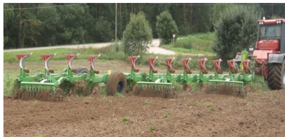
Рисунок 4. – 12-ти корпусный оборотный плуг ПО-(8+4)-40
