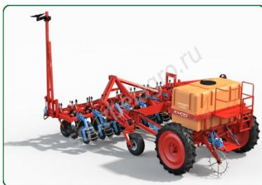
Второй важной особенностью является автоматически изменяемая высота сцепного устройства (дышла) вместе с подъемом и опусканием почвообрабатывающего орудия при переводе его в рабочее и транспортное положение. Это позволяет подкормщику «АГРИДЖЕТ»-03 агрегатироваться с любыми (прицепными или навесными) почвообрабатывающими орудиями и посевными агрегатами и иметь всегда строго вертикальное положение (что очень важно для равномерного внесения удобрений и распределению веса подкормщика).
