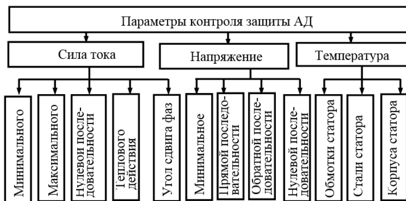
Рисунок 1– Классификация параметров контроля аварийных режимов АД
