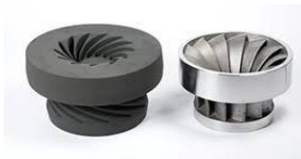
Рис. 6.24. Песчано-полимерная форма, полученная с помощью SLS-технологии
