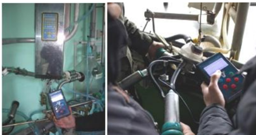
Рис. 2.6. Применение комплекта приборов для контроля технических параметров молочно-доильного оборудования в производственных условиях
