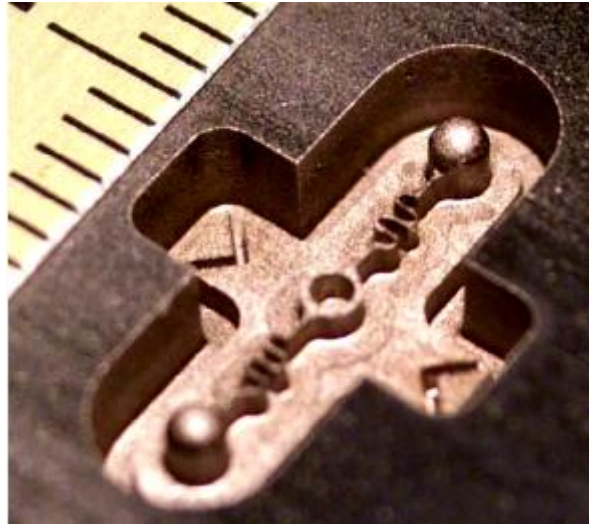
Рис. 3.24. Электроэрозионно-фрезерная обработка микрополостей сложной формы
