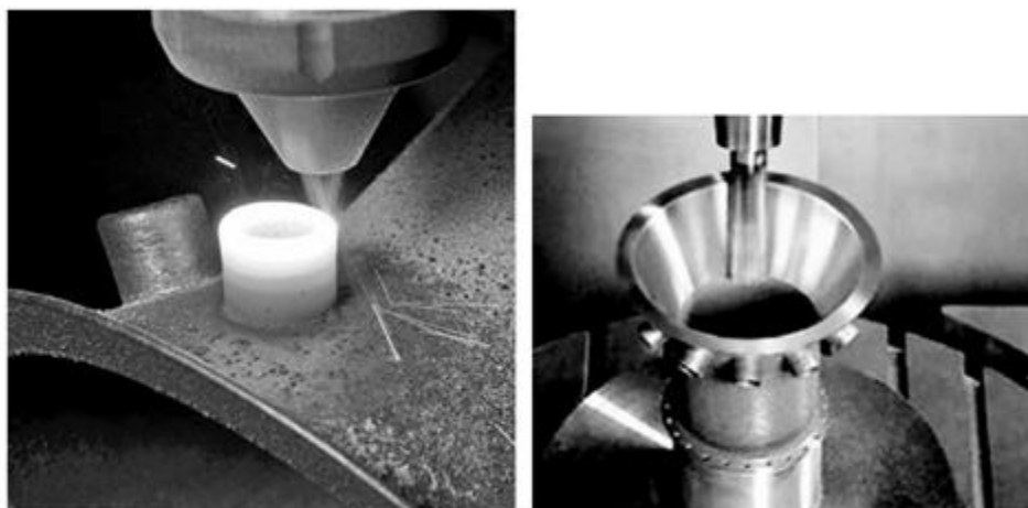
Рис. 6.12. Селективная послойная наплавка с одновременной механической обработкой
