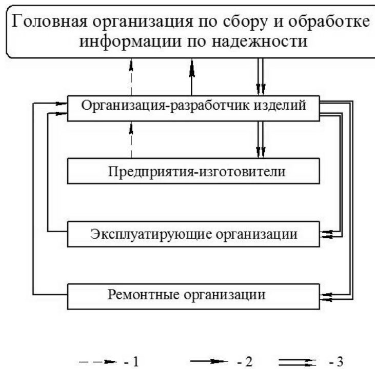
Рис. 1.4. Типовая схема организации сбора и обработки информации о надежности автомобилей
