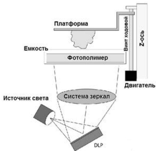
Рис. 6.4. Схема DLP-процесса
