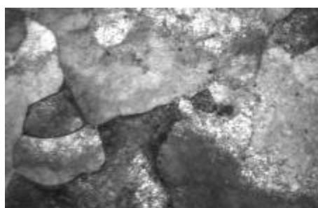
Рис. 5.4. Структура приграничного слоя в никеле при электровзрывном науглероживании (кристаллиты Ni 3 C)
