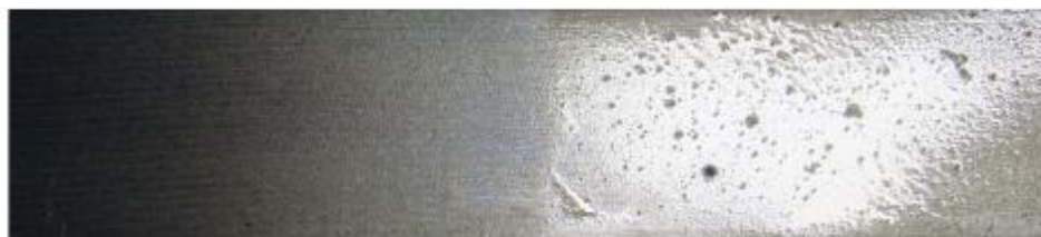
Рис. 3.3. Лазерная очистка стальной полосы от масляной пленки (слева – очищенная часть)
