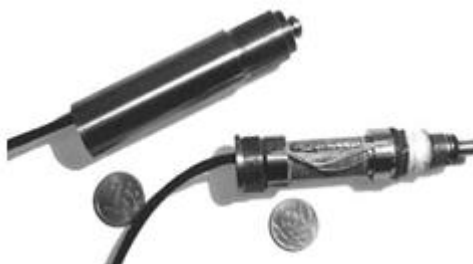
Рис. 2.26. Пьезодвигатель с встроенным индуктивным датчиком микроперемещений
