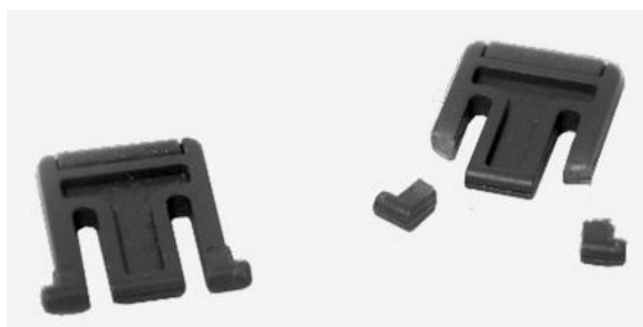
Рис. 6.40. Восстановленная с помощью 3D-принтера и сломанная деталь из пластика
