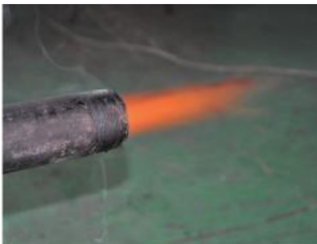
Рис. 3.12. Продукты полного сгорания истекают из трубы в охлаждаемый газовой (газовод снят)
