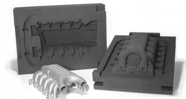
Рис.6.25. Песчано-полимерная форма, полученная с помощью Ink-Jet-технологии
