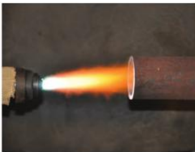
Рис. 3.11. Плазматрон внутренней очистки вводят в трубу на всю ее длину
