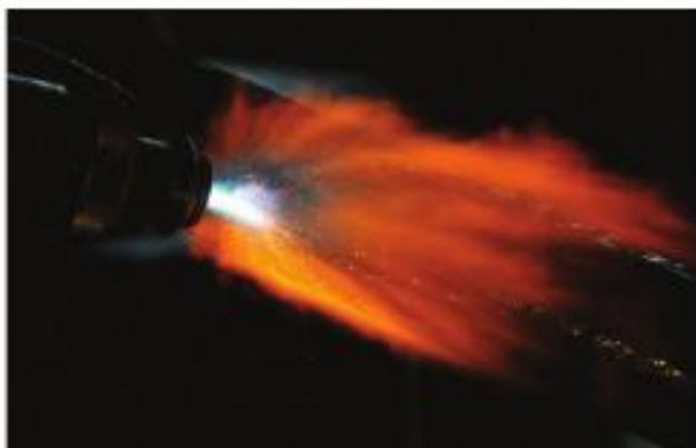
Рис. 3.10. Очистка наружной поверхности НКТ струей плазмы
