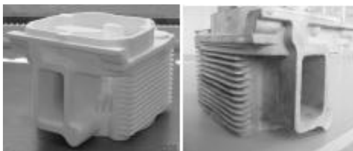
Рис. 6.22. Головка цилиндра ДВС: SLS-модель (слева) и отливка
