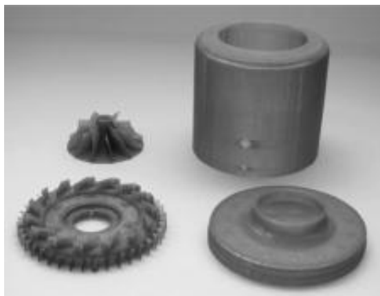
Рис. 6.20. Детали из термостойких пластиков, изготовленные с помощью FDM-технологии
