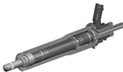
Рис. 2.27. Пьезофорсунка для впрыска бензина: подача электрического напряжения вызывает расширение пьезокерамического столба, который приподнимает дозирующую иглу
