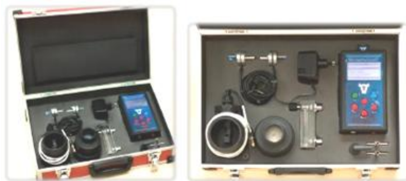
Рис. 2.5. Общий вид комплекта приборов для контроля технических параметров молочно-доильного оборудования
