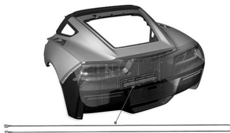
Рис. 2.20. Привод вентиляционной заслонки в багажнике автомобиля в виде струны из сплава с ЭПФ
