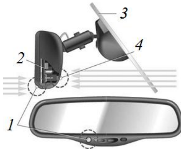
Рис. 2.12. Автоматически темнеющее зеркало заднего вида 1 – фотодатчик, направленный назад, 2 – электронная плата, 3 – ветровое стекло, 4 – фотодатчик, направленный вперед
