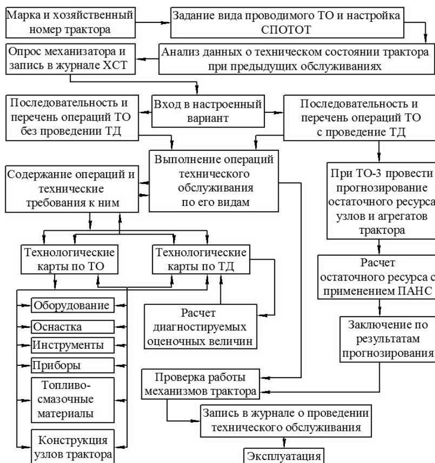
Рис 1.9. Блок-схема использования СИОТОТ в технологическом процессе ТО тракторов
