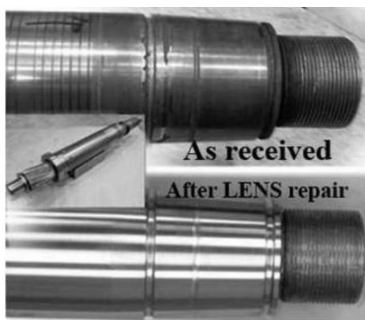
Рис. 6.38. Сравнение вала, восстановленного газотермическим напылением (вверху) и LENS-технологией (внизу)
