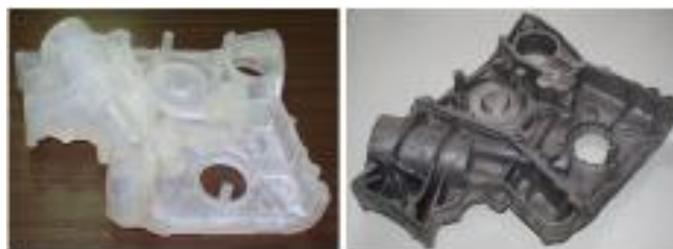
Рис.6.23. Передняя крышка ДВС: SLA-модель (слева) и отливка (справа)
