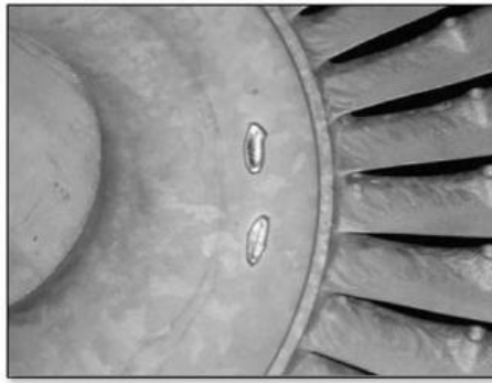
Рис. 6.31. Устранение литейных дефектов в виде пор на поверхности колеса. Основа колеса выполнена из никелевых/титановых сплавов, наплавка – из того же материала
