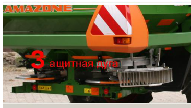
Рисунок 8 – Оснащение Limiter для внесения удобрений на границе поля в рабочем положении
