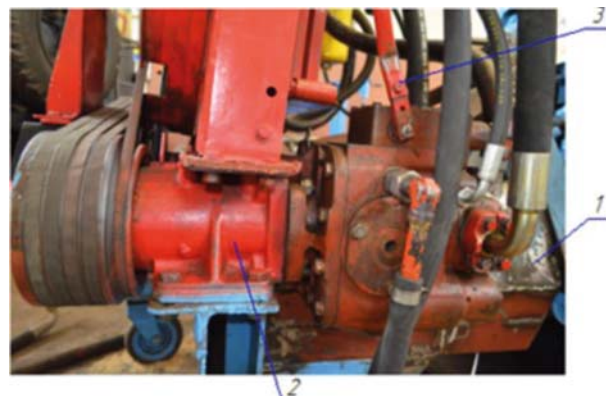
Рисунок 2. Монтаж гидронасоса ГСТ: 1 – диагностируемый насос; 2 – промежуточная опора; 3 – рычаг гидрораспределителя
