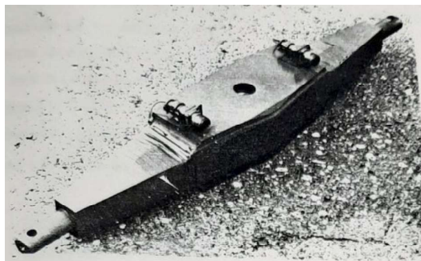
Рисунок 1. Тензометрическое тяговое звено для измерения силы сопротивления качению машин
