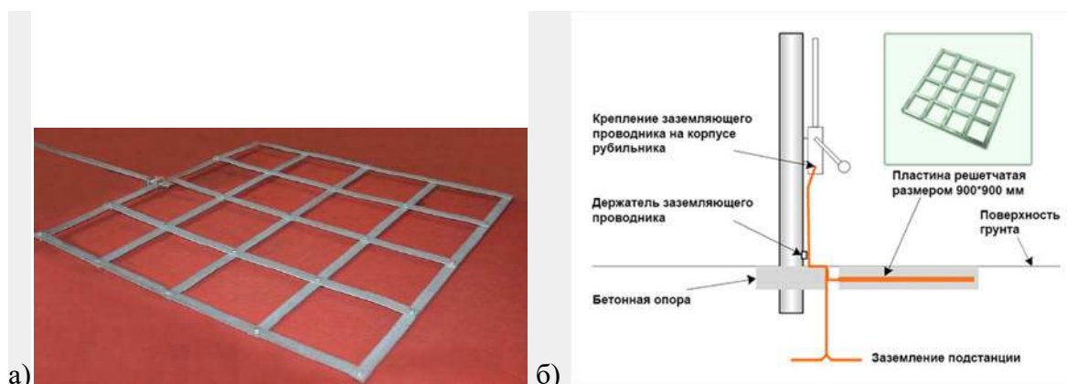
Рис. 3 – Внешний вид (а) и возможный вариант применения (б) пластин решетчатых.
