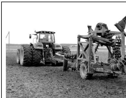
Рисунок 2 – Лушильник ЛДР-9 в транспортном положении
