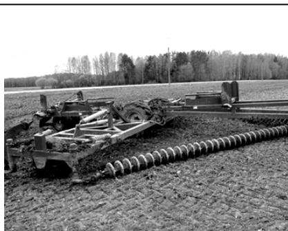
Рисунок 3 – Лушильник ЛДР-9 в рабочем положении
