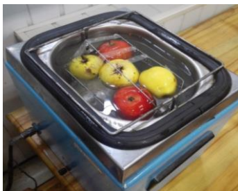
Рис. 1. Перемешивание яблок вращающимся барабаном в УЗ ванне
