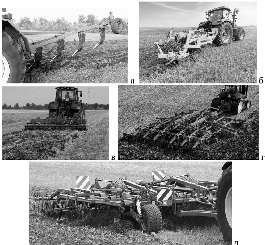
а – плуг общего назначения оборудованный безотвальными корпусами;
