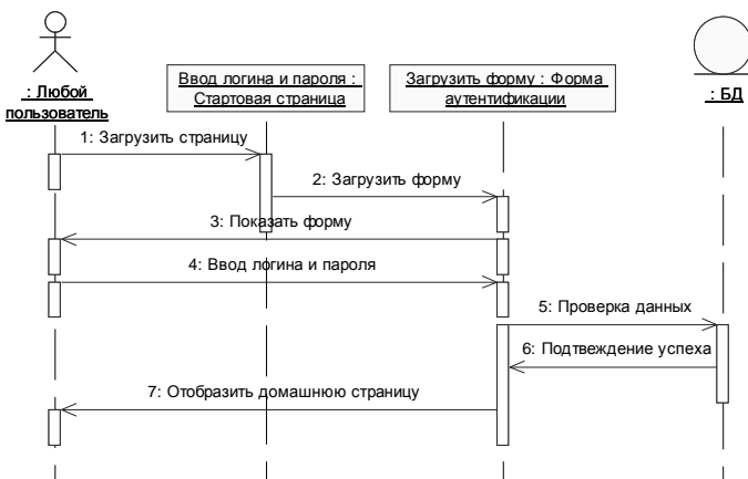
Рисунок 3 – Диаграмма последовательности основного потока
