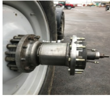
Рисунок 1 – Опорно-сцепное устройство задних двояных колес трактора «БЕЛАРУС» тягового класса 5.0
