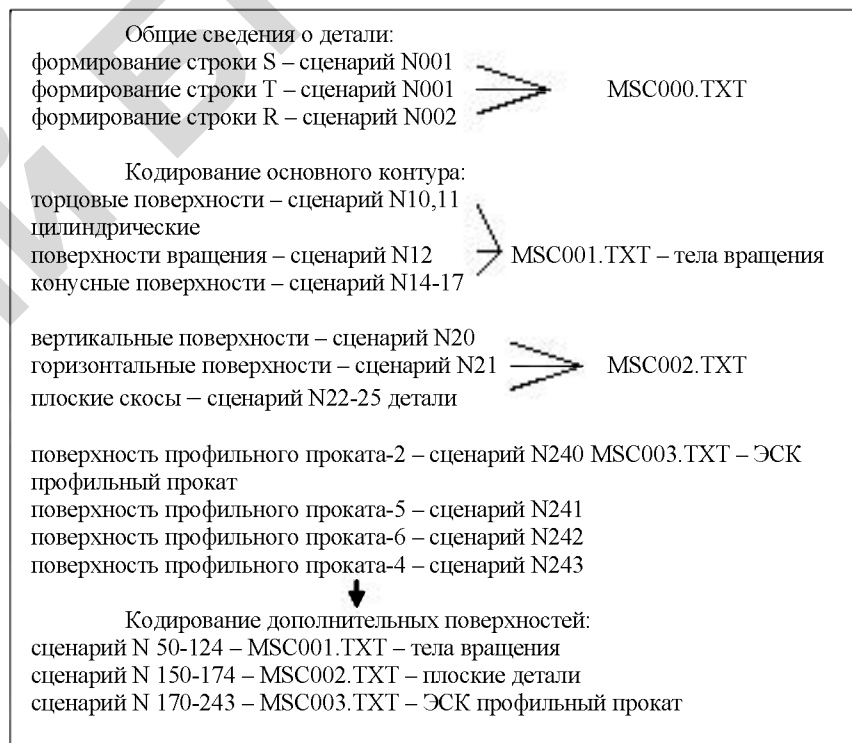
Рис. 6.36. Схема кодирования чертежа детали
