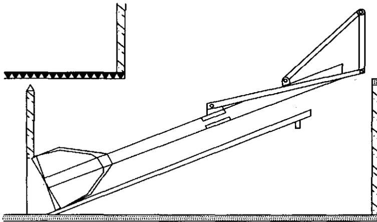
Рисунок 2. Гомогенизатор в навозном канале.
