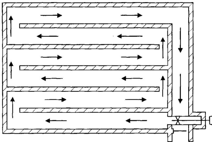
Рисунок 1. Схема движения навозной массы.
