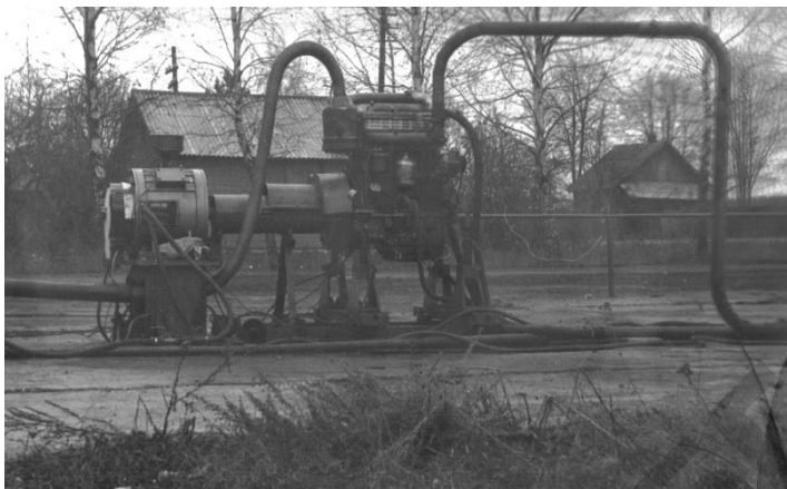
Рис.1. Стенд для акустических испытаний двигателей в открытом звуковом поле
