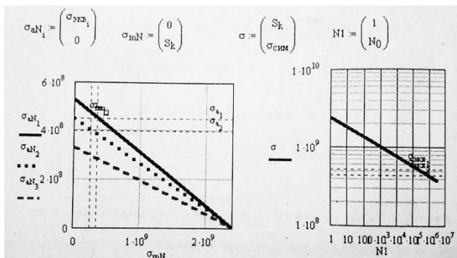
Рисунок 5 – Усталостная кривая для симметричного цикла нагружения
