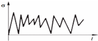
Рисунок 1 – Циклограмма нагружения при нестационарных нагрузках
