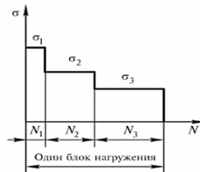
Рисунок 2 – Гистограмма нагружения при нестационарных нагрузках
