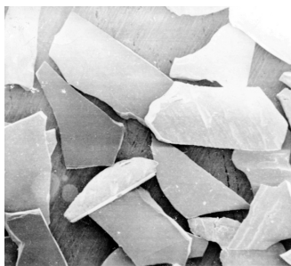
Рисунок – Внешний вид частиц ФАП на основе аморфного металлического сплава (100-кратное увеличение)
