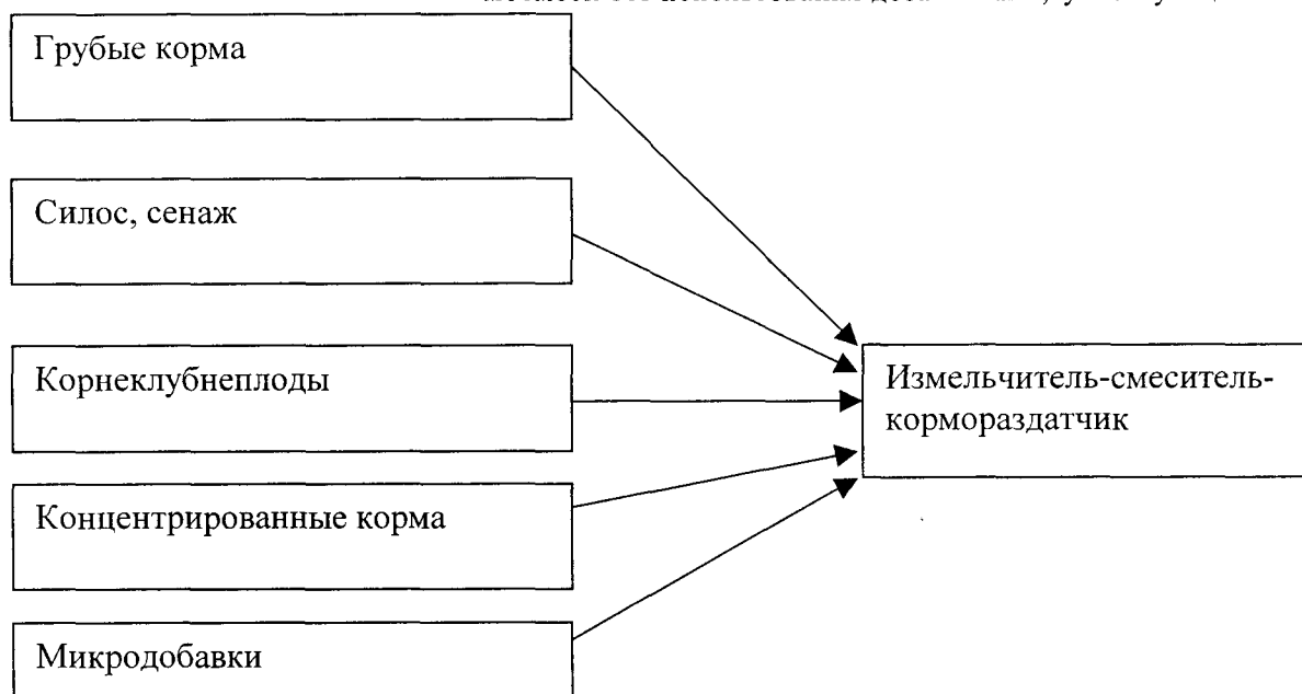
Рис.2. Схема приготовления кормосмеси измельчителями-смесителями-кормораздатчиками, оборудованными весоизмерительными устройствами и механизмами самозагрузки
