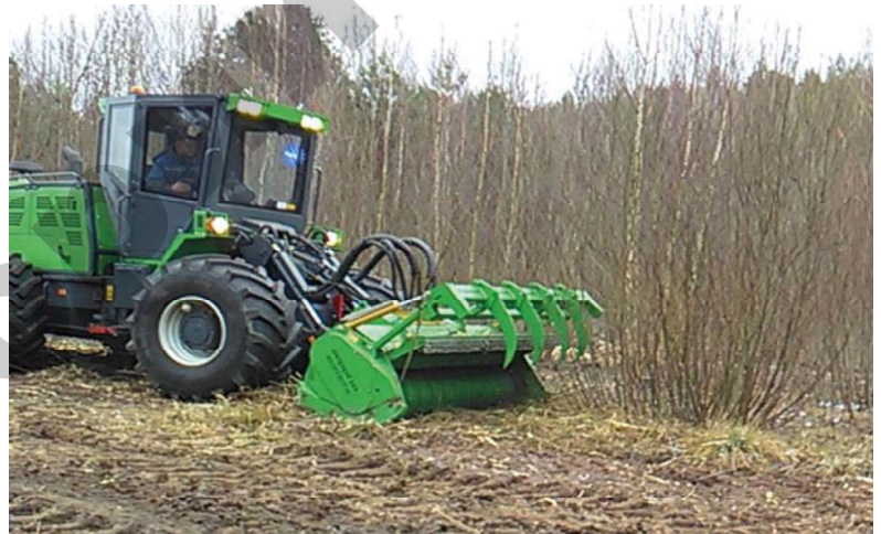
Рисунок 2. Измельчение древесно-кустарниковой растительности опытным образцом универсального лесного шасси, агрегатируемого с мульчером
