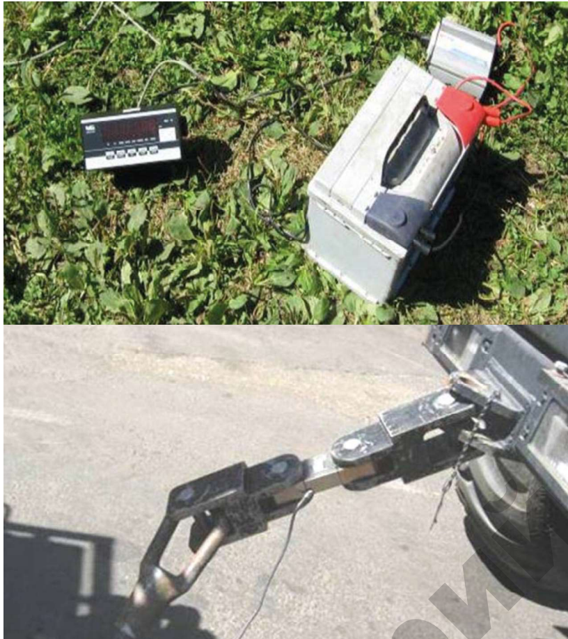
Рисунок 5. Оборудование для определения усилия сопротивления движению и тяги универсального лесного шасси
