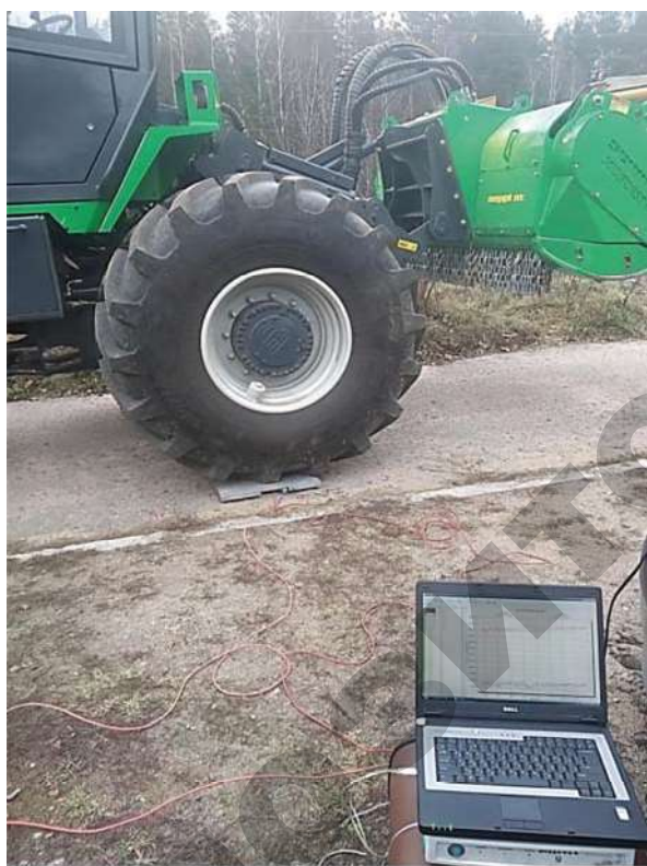
Рисунок 4. Измерение нагрузки под колесом машины
